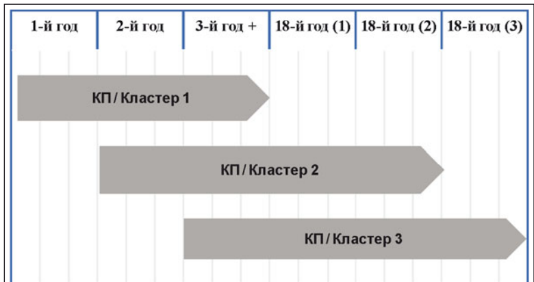
Рис. 7. Пример дорожной карты с параллельным запуском кустовых площадок/кластеров с применением нескольких установок
